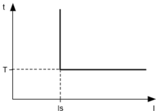
Рисунок 1.2 - Принцип защиты с независимой выдержкой времени
