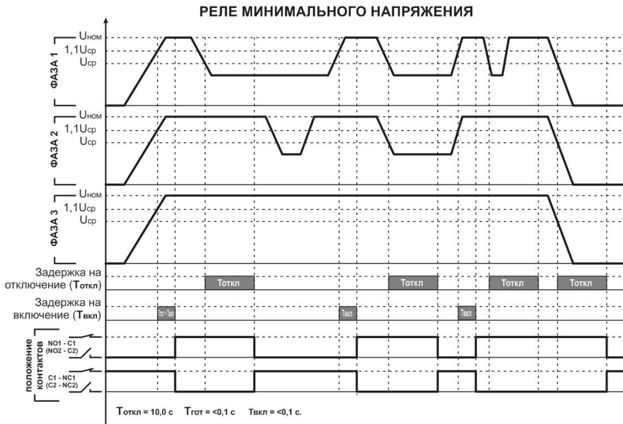
Рисунок 4 – Диаграмма работы изделия в режиме реле минимального напряжения
