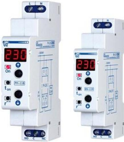
Реле напряжения РН-118 и РН-119 предназначены для отключения бытовой и промышленной однофазной нагрузки любой мощности при недопустимых колебаниях напряжения в сети с последующим автоматическим включением после восстановления параметров сети.
