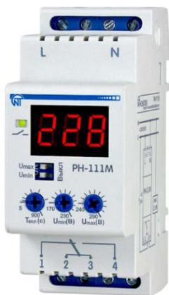
**Реле напряжения РН-111М** предназначено для отключения бытовой и промышленной однофазной нагрузки 220 В, 50 Гц при недопустимых колебаниях напряжения в сети с последующим автоматическим включением после восстановления параметров сети.
