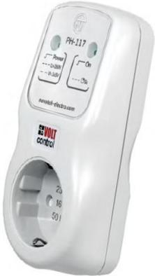
**Реле напряжения РН-117** предназначено для отключения бытовой и промышленной 1-фазной нагрузки 220 В, 50 Гц мощностью до 3,5кВт (до 16 А) при недопустимых колебаниях напряжения в сети с автоматическим повторным включением (в дальнейшем АПВ) после восстановления параметров сети.
