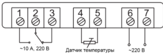
Схема подключения. Реле ~10 А, 250 В
