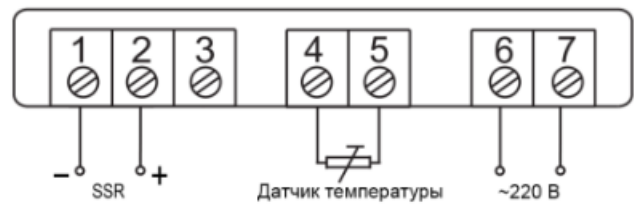
Схема подключения. SSR – управление твердотельным реле
