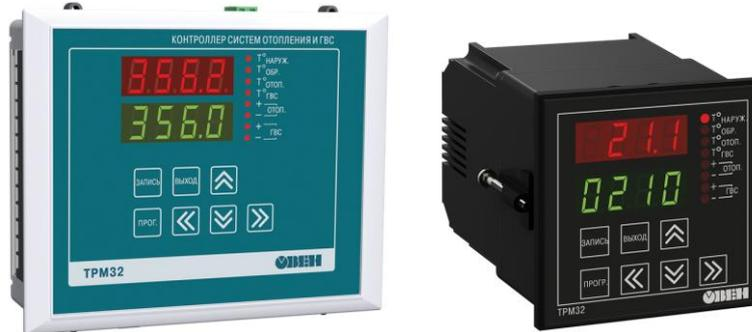
**ОВЕН ТРМ32** – контроллер с готовым алгоритмом регулирования температуры в системах отопления и ГВС. Предназначен для применения в индивидуальных и центральных тепловых пунктах (ИТП и ЦТП) и котельных. Регулятор отопления и ГВС поддерживает температуру по заданной уставке или отопительному графику, управляя запорно-регулирующим клапаном (КЗР).
