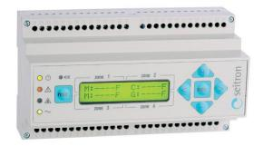
Блок питания и сигнализации для 8 внешних сенсоров типа SGY и SY на метан, пропан-бутан и угарный газ. Световая и звуковая сигнализация. Отображение концентрации на дисплее в каждой зоне. В приборе имеются 5 выходных реле, два из них вспомогательные настраиваемые.
