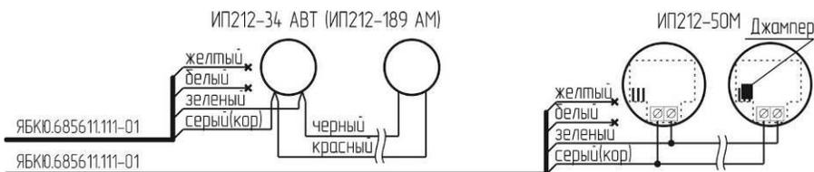
б) схема электрическая подключения пожарных извещателей
