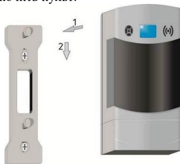
Рисунок 6 – Установка сигнализатора на монтажную панель
