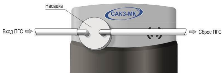
Рисунок Ж.1 – Схема установки насадки
