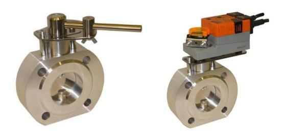
Заслонки газовые дроссельные ЗГД предназначены для регулирования объемных расходов газовых сред - природного газа, газовых фаз сжиженных газов, воздуха и других неагрессивных газов. Используются в системах газоснабжения, газогорелочных устройствах и на аналогичном оборудовании для плавного или ступенчатого регулирования расхода в процессах сжигания газа.
