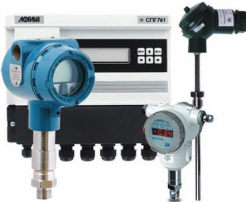
Измерительные комплексы газа ЛОГИКА 1764 предназначены для измерения расхода и объема при рабочих условиях природного газа, технических газов различного состава, температуры окружающего воздуха, атмосферного давления и других параметров контролируемой среды и приведения результатов измерений расхода и объема газа к стандартным условиям.
