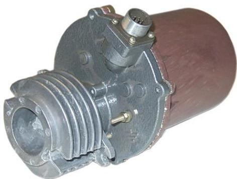
Предназначен для контроля и сигнализации наличия пламени запальника и пламени горелки.
