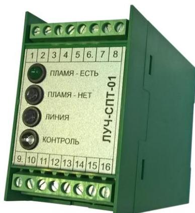
Сигнализатор горения ЛУЧ-СПТ-01 обеспечивает визуальную индикацию и электрический выходной сигнал, который сигнализирует о наличии или отсутствии пламени в камере сгорания. Сигнализатор использует оптический УФ датчик ФДА-03 для определения наличия пламени самостоятельно или в качестве компонентов системы управления горелкой.
