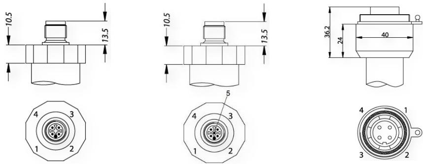
Код M00 или M10 (Разъем M12x1, 4-конт. / IP 67 или разъем M12x1 металлический, 4-конт. / IP 67)
