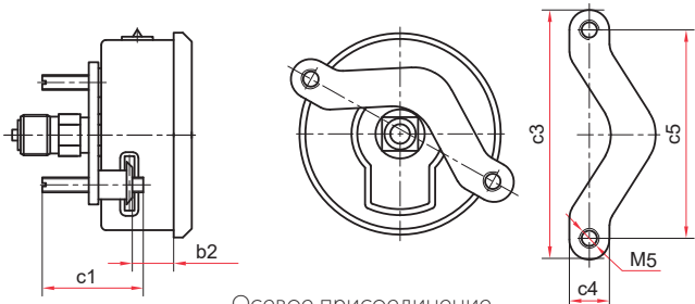
Осевое присоединение со скобой тип 2, завальцованные (Ø63 мм)
