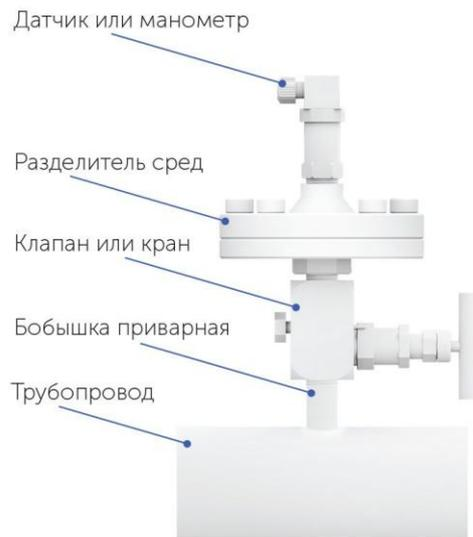
Для защиты чувствительного элемента датчика давления от контакта с агрессивной, вязкой или абразивной измеряемой средой рекомендуется устанавливать прибор в сборе с мембранным разделителем сред, заполненным разделительной жидкостью.
