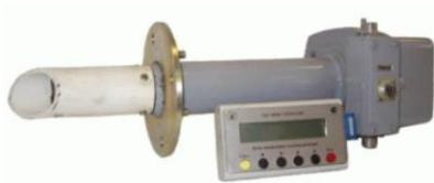
СО-МАДГ-1 - микропроцессорный автоматический анализатор оксида углерода, предназначенный для непрерывного измерения концентрации оксида углерода в дымовых газах с целью технологического и экологического контроля. Наиболее целесообразно его применение в системах автоматического контроля и регулирования процессов сжигания топлива.
