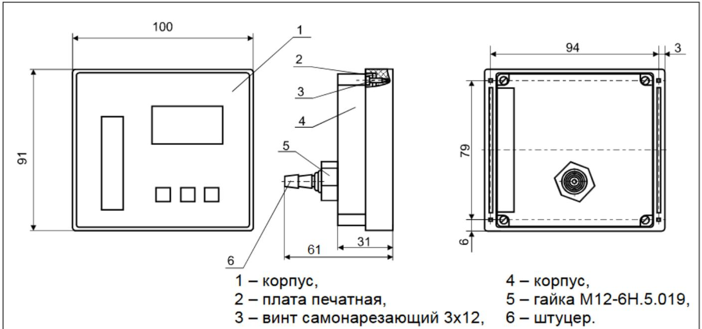
Внутренний диаметр присоединительной трубки, при помощи которой подается измеряемая среда, равен 6мм. Рекомендуется использовать рукав I-6,3-0,63-У ГОСТ 9356-75 (рукава резиновые для газовой сварки и резки металлов).
