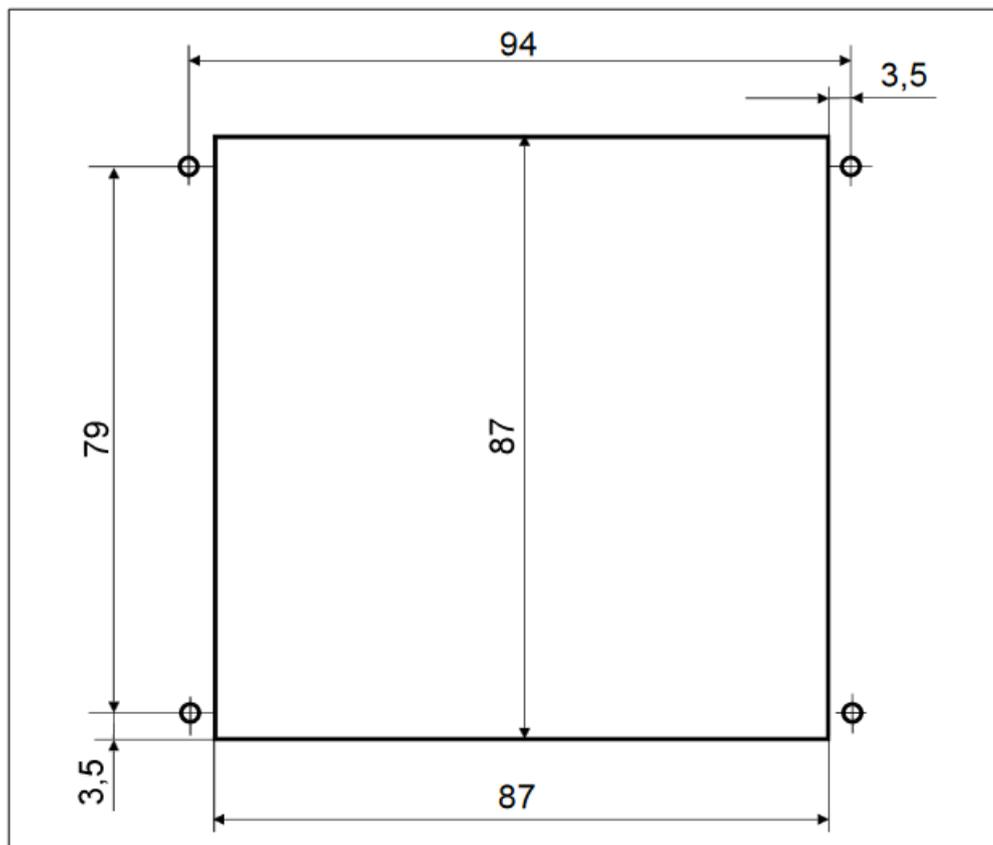
Диаметр отверстий в щите – 4 мм.
