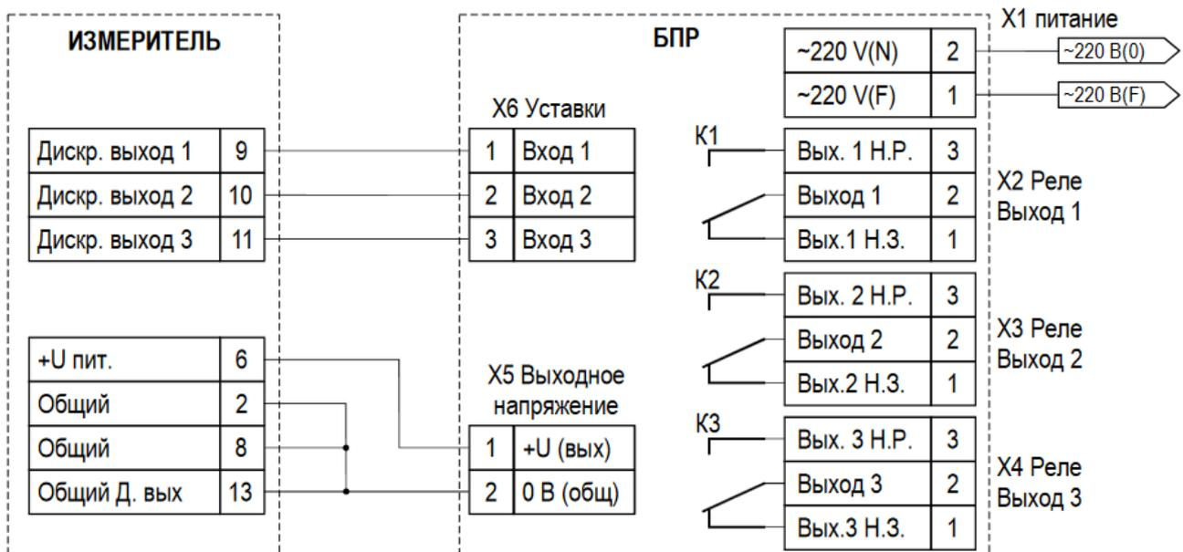
**Схема подключения реле к дискретным выходам измерителя (внешние цепи гальванически связаны с цепью «Общий» измерителя)**
