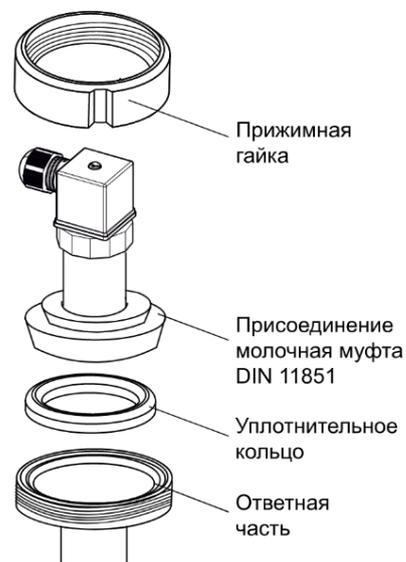
Монтаж ПД180 с присоединением «молочная гайка» по стандарту DIN 11851
