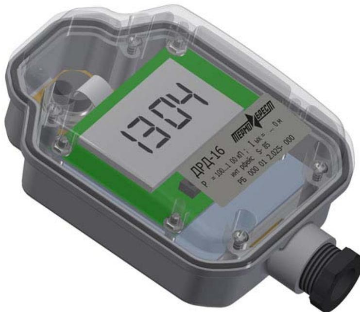
Датчики-реле давления ДРД-16 используются для контроля избыточного давления газа или воздуха в системах газоснабжения. Величина контролируемого давления выводится на цифровой индикатор расположенный на лицевой панели датчика. При достижении установленного значения обеспечивает выдачу сигнала замыканием контактов реле в систему автоматики. Контроль величины избыточного давления также обеспечивается сигналом токового выхода 4...20 мА или по интерфейсу RS-485 по протоколу Modbus-RTU.
