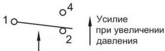
Схема подключения электрических контактов
