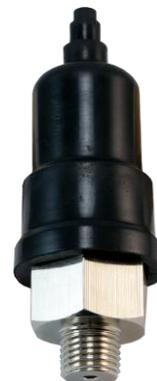
**Принцип действия:** При давлении среды ниже заданного контакты реле разомкнуты. При достижении установленного значения давления среда выгибает мембрану, контакты реле замыкаются. При снижении давления мембрана возвращается в исходное положение, и реле размыкается.
