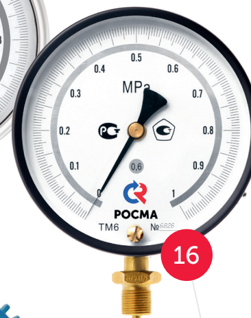
Манометры точных измерений с корректировкой нуля
