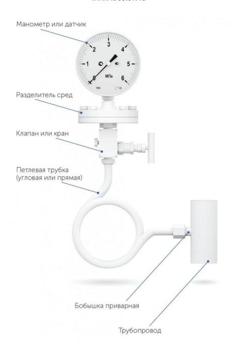
Типовой узел отбора для подключения манометра состоит из приварной бобышки с площадкой под уплотнительную прокладку, петлевой трубки, трехходового крана или игольчатого клапана. В качестве уплотнения в резьбовых соединениях между приварной бобышкой, краном и манометром рекомендуется применять паронитовую, фторопластовую или медную прокладку.
