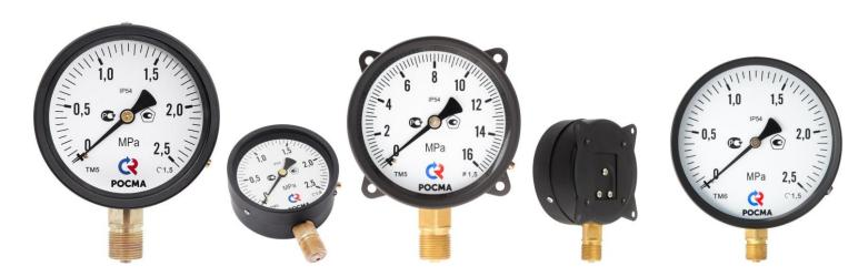
**Тип ТМ (ТВ, ТМВ), серия 10, IP54.** Манометры общетехнические с повышенной пылевлагозащищенностью, предназначены для использования в условиях с повышенными эксплуатационными требованиями. Преимуществами данного исполнения являются **повышенная износостойкость** механизма, **улучшенная защита** от внешних воздействий (IP54), **встроенный демпфер**.
