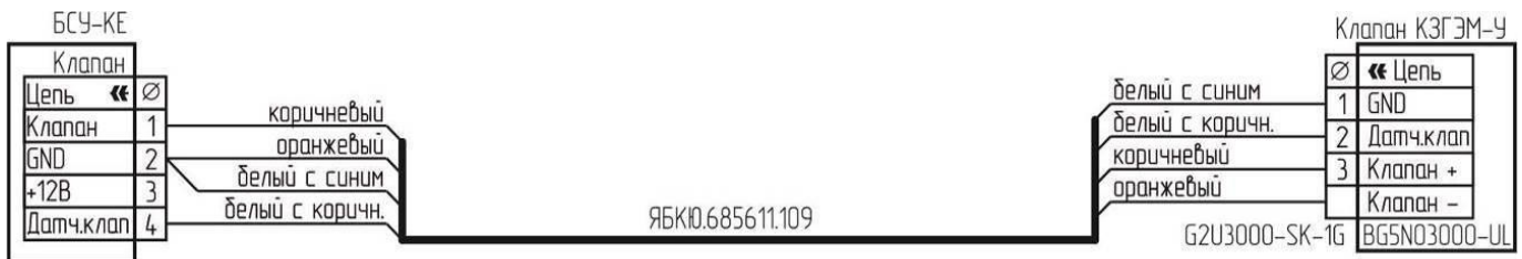
Рисунок А.3 – Типовая схема подключения клапана КЗГЭМ-У с разъемом BG5N03000-UL
