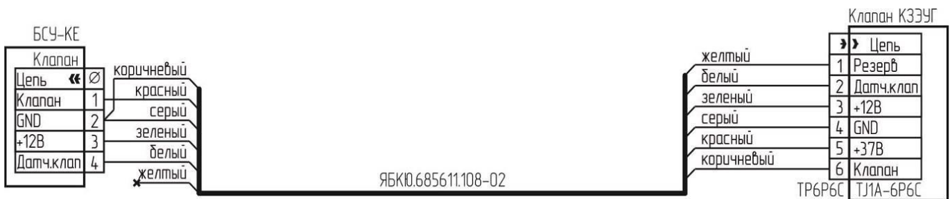
Рисунок А.5 – Типовая схема подключения клапана КЗЭУГ с разъемом TJ1A-6P6C
