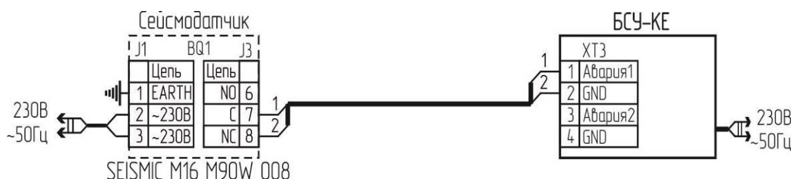
Рисунок 17 – Схема подключения сейсмического сенсора SEISMIC M16 M90W 008.
