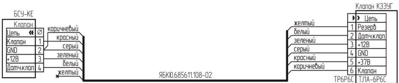
Рисунок Г.5 – Типовая схема подключения клапана К3ЭУГ с разъемом TJ1A-6P6C
