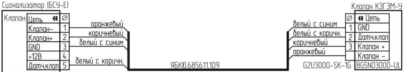
Рисунок В.2 – Схема подключения клапана КЗГЭМ-У с разъемом BG5NO3000-UL
