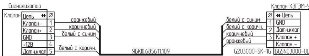
Рисунок В.2 – Схема подключения клапана КЗГЭМ-У с разъемом BG5N03000-UL.
