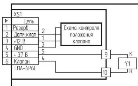
а) с разъемом типа TJ1A-6P6C
