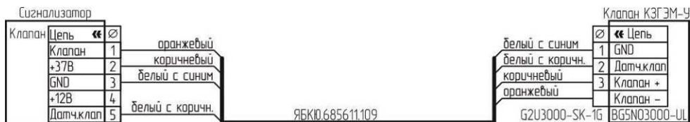
Рисунок Б.4 – Схема подключения клапана КЗГЭМ-У с разъемом BG5NO3000-UL.
