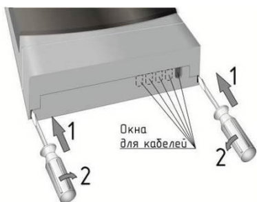
Рисунок 2 – Снятие крышки клеммного отсека
