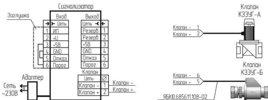
Рисунок Г.2 – Схема подключения клапана к СЗ-2-2АГ с клеммником «Клапан»
