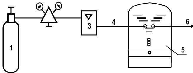
1 – баллон с газовой смесью; 2 – редуктор; 3 – ротаметр; 4 – трубка ПВХ;
