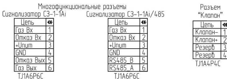
Рисунок 2 – Обозначение электрических цепей на разъемах.
