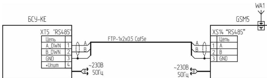
Рисунок 7 – Схема подключения для программирования адреса
