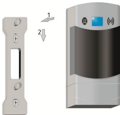
Рисунок А.3 – Установка блока на монтажную панель
