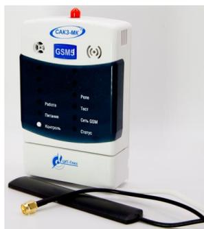
**предназначен для** передачи информации о состоянии входных сигналов с использованием встроенного модуля связи стандарта GSM-900/1800. Информация передается посредством SMS сообщений.
