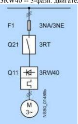
3RW40 -- 3-фазн. двигатель с выключателем 3VL
