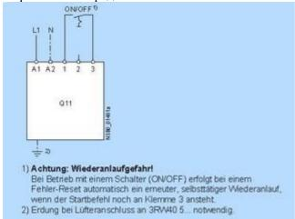
Управление посредством выключателя с использованием внешн. источника напряжения
