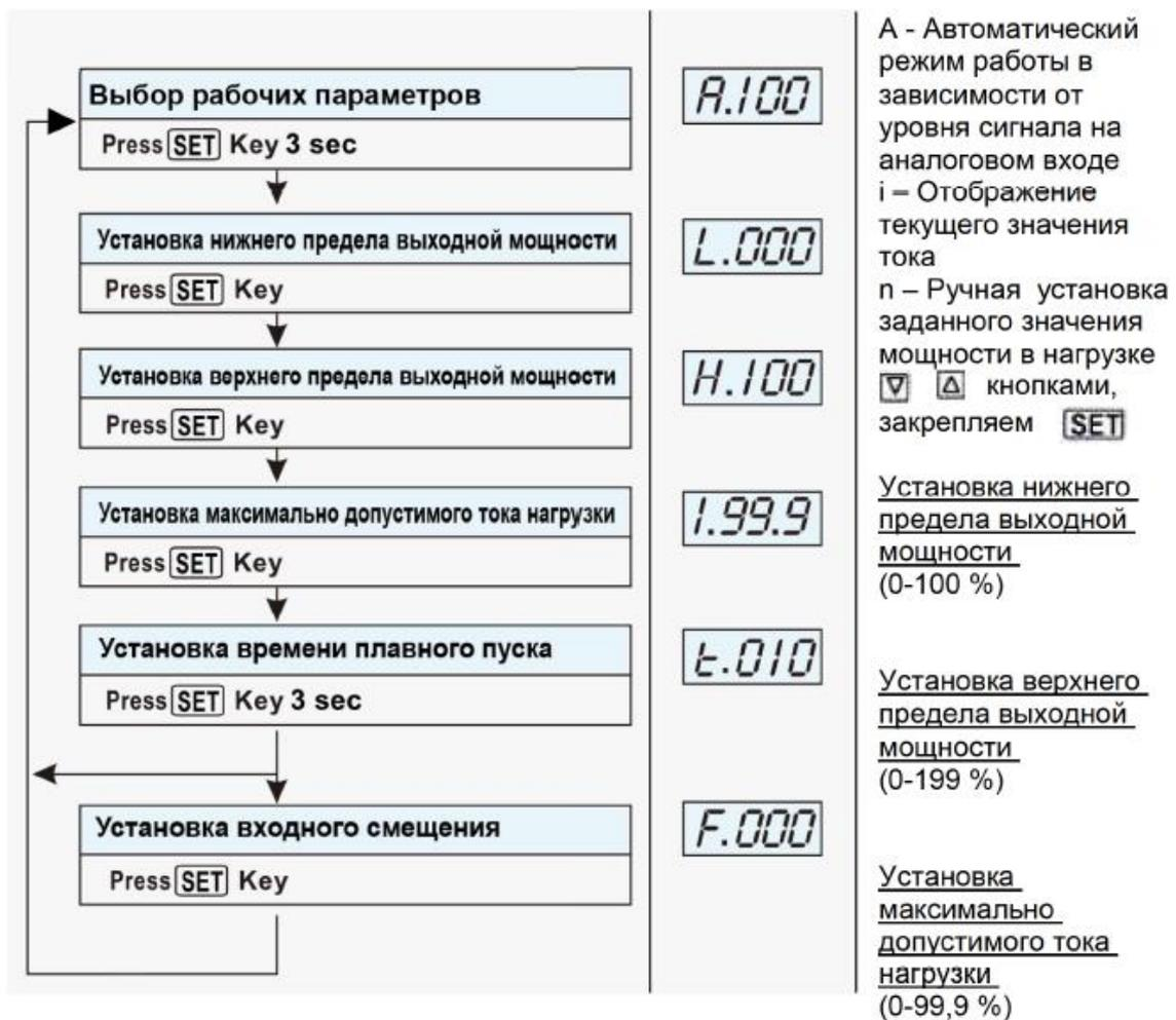
Установка времени плавного пуска (0-199 сек)
