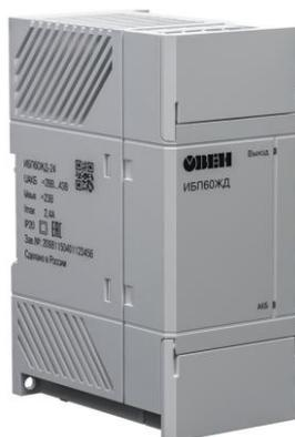
**ОВЕН ИБП60ЖД-24 предназначен** для использования в качестве резервированного источника вторичного питания при работе от источника постоянного тока ОВЕН БП60К 24 В или от резервной сети питания постоянного тока ЖД станций (28...43 В).
