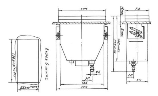
Габаритные размеры - 72х144х175 мм (вырез в щите – 66х138 мм)
