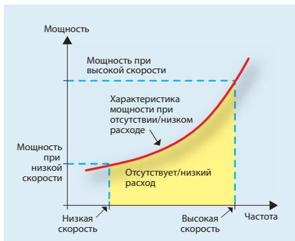
**Защита от сухого хода насоса снижает затраты на закупку дополнительного оборудования и техническое обслуживание**
