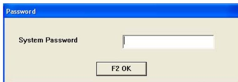
Без ввода пароля (нажать F2), система будет находится на уровне пользователя. Уровень пользователя позволяет вывести оси в ноль,перемещать их в ручном режиме и исполнять уже созданные программы.
