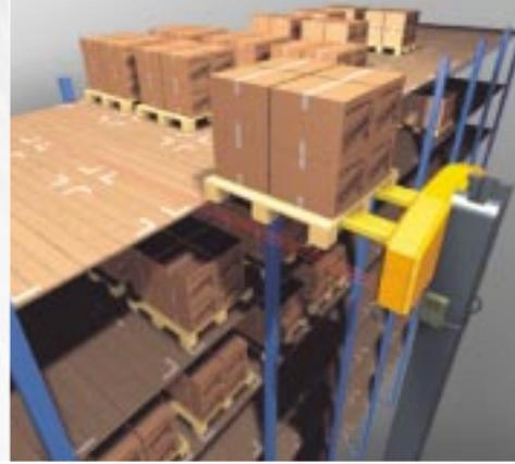
Два выхода позволяют определить, сколько поддонов содержит ячейка стеллажа - один, два или больше
