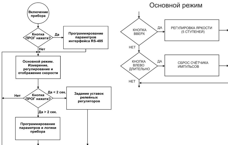
Рис. 3.1. Блок-схема доступа к элементам меню прибора
