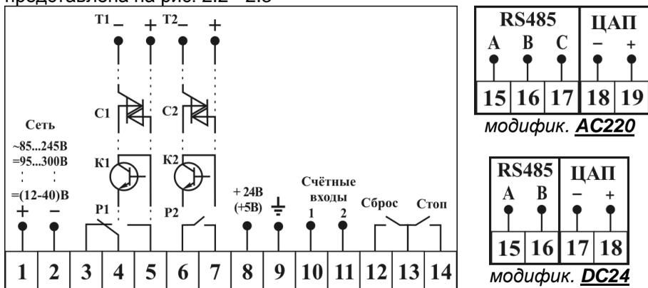
Рис. 2.2. Схема подключения прибора (кроме исполнения H57)
