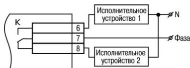
Схема подключения нагрузки к ВУ типа Р
