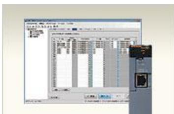
Утилита для конфигурирования высокоскоростного модуля регистрации данных MELSEC System Q.
