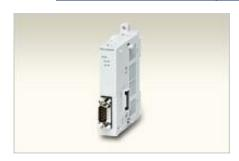
Коммуникационные модули RS-232, RS-485, RS-422. Также можно подключить мастер модуль CC-Link серии FX3.
