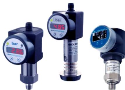
Многофункциональный индикатор PA 430 представляет собой сочетание цифрового дисплея и программируемого реле с дискретным выходом. Индикатор является универсальным для всех датчиков с типом электрического разъема DIN 43650 и выходным сигналом 4..20 мА по 2-х проводной схеме подключения.
