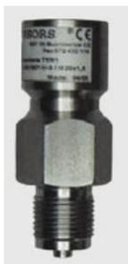
Демпферы гидроударов серии TTR разработаны специально для датчиков давления с тензометрическими сенсорами, которые обычно выдерживают 4-кратную перегрузку. В начале работы различного технологического оборудования, в некоторых случаях, даже при нормальных условиях эксплуатации, возникают удары давления большой интенсивности и очень короткой продолжительности, которые могут явиться причиной выхода датчика из строя.
