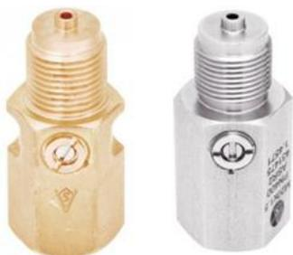
Демпфирующее устройство с регулировочной иглой используется в комплекте с манометром или датчиком давления при измерении давления в средах с повышенной пульсацией и при возможных гидравлических ударах. Оно позволяет снизить уровень пульсации среды и защитить чувствительный элемент прибора от повышенного износа.
