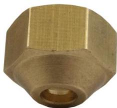
Переходник с G $\frac{1}{4}$ " под расклейку к ДР-Д, ДР-2Д, ДР-ДД. Используется для присоединения развальцованной капиллярной трубки диаметром 6,5 мм к штуцеру реле давления.
