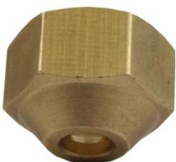
Переходник с G7/16" под расклепку к ДР-Д, ДР-2Д, ДР-ДД. Используется для присоединения развальцованной капиллярной трубки диаметром 6,5 мм к штуцеру реле давления с помощью переходника ПТСТ-G1/4-7/16
