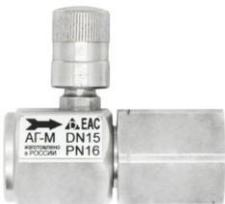
Кнопочный запорный клапан АГ-М (аналог клапана VE2-2) предназначен для перекрытия потока рабочей среды к манометру на низкие давления КМ (напоромеру) или ТМ, а также для снижения постоянной нагрузки давления среды, которая негативно сказывается на чувствительном элементе прибора – мембране или трубке Бурдона. Длительное нахождение мембраны под давлением ухудшает метрологические свойства прибора (снижается точность показаний).
